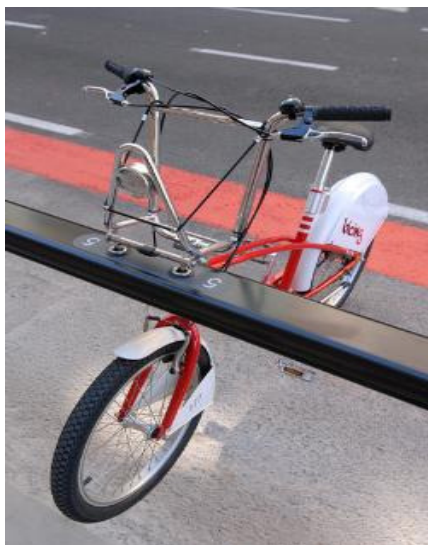
Exemplo 10, Detalhe engate e travamento, Barcelona
